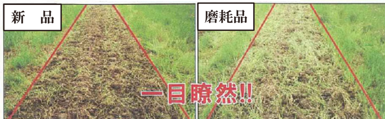
新しい爪と磨耗爪との耕うん性能比較
